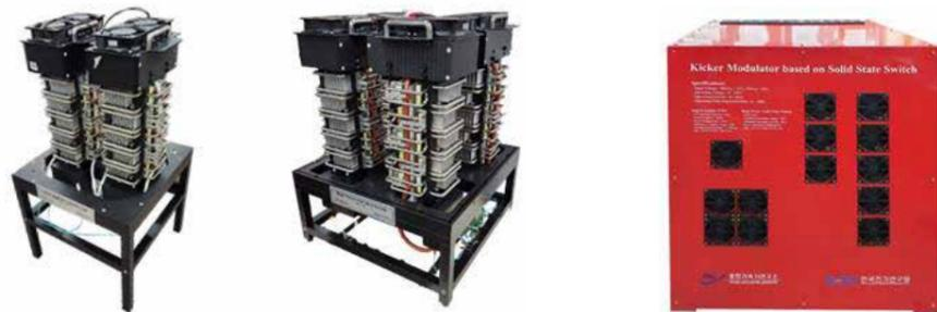
[ 25kV, 10kA & 50kV, 10kA 대용량 스위치 시작품 ]
